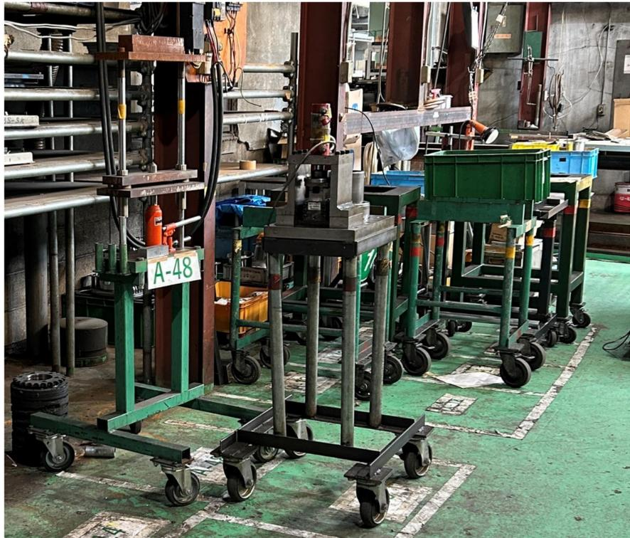
改善前：金型と台車が一体となっており、ラインから離れた場所に使用しない金型を待機させていた。段取りの際には台車が不安定なため二人で運搬していた。
