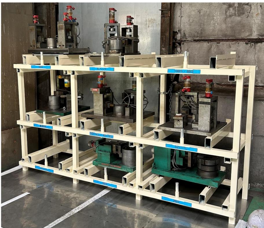
改善後：ライン側に棚を新設し、金型と台車を分離させ省スペース化。台車はライン内にある1台のみとし、段取り時に棚から金型を移動する際はリフターを使用してライン内まで入れ込むことで従来二人かかっていた作業を一人で行えるようになった。
